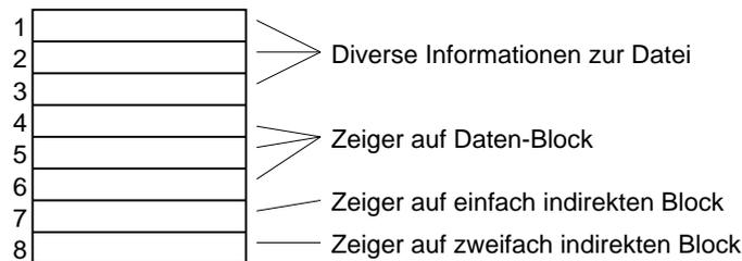
Die Daten sind also über 3 direkte Blöcke, einen einfach und einen zweifach indirekten
